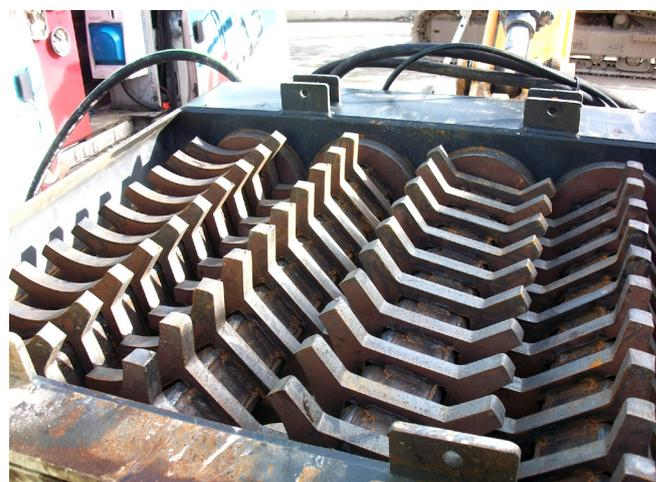
*Verschleißfestes Blech, eine leistungsfähige Hydraulik und synchronisierte Wellen sind die Merkmale des neuen Schaufelseparators SkanCraft Claymaster. Fotos: RSS System*
